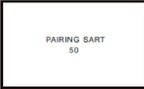
Um die Verbindung zwischen Bildschirm und Kamera herzustellen, müssen beide Geräte eingeschaltet sein. Über die Menüauswahl „PAIR“ wählen und mit „OK“ bestätigen. Es erscheint die Anweisung „Pairing start 50“, innerhalb von 50 Sekunden die Kamera aus und wieder einschalten. Nach 5 bis 10 Sekunden erscheint das Bild der Kamera auf dem Display.
